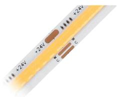
2880LEDs, kürzbar alle 2,78cm, Striplänge je Anfangseinspeisung max. 5m
