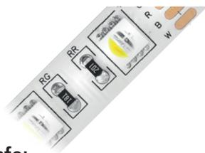
300 LEDs, kürzbar alle 10cm, Striplänge je Anfangseinspeisung max. 5m
