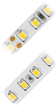
600 LEDs, kürzbar alle 5cm, Striplänge je Anfangseinspeisung max. 5m
