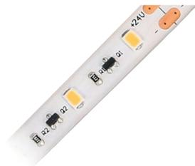
600 LEDs, kürzbar alle 10cm, Striplänge je Anfangseinspeisung max. 20m
