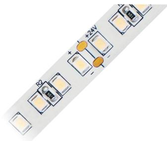
1950 LEDs, kürzbar alle 10cm, Striplänge je Anfangseinspeisung max. 30m
