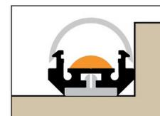
Eck-Montage mit Montage-Clip, Wand-Bohrabstand 11 mm
