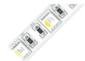
300 LEDs, kürzbar alle 10cm, Striplänge je Anfangseinspeisung max. 5m
