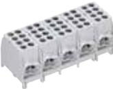
**Hauptleitungs-Abzweigklemme** zur Montage auf Tragschiene 35mm, fingersicher, Isolierkörper aus hochkriechstromfestem Polyamid mit Stahl-Klemmschrauben galvanisch verzinkt, 4 Klemmstellen je Pol, 400V
