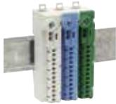
**Sammel-Klemme mit Steckklemmen**, aufrastbar auf Hutschiene, 12 Steckklemmen bis max. 2,5mm<sup>2</sup> starr oder 1,5mm<sup>2</sup> flexibel mit Endhülse, 2 Steckklemmen bis max. 4mm<sup>2</sup> starr oder 2,5mm<sup>2</sup> flexibel mit Endhülse, 1 Schraub-Rahmenklemme bis max. 25mm<sup>2</sup> starr bzw. 16mm<sup>2</sup> flexibel mit Endhülse, Klemme gemäß EN 60998/VDE 0613, fingersicher gemäß VBG4/BGV A2
