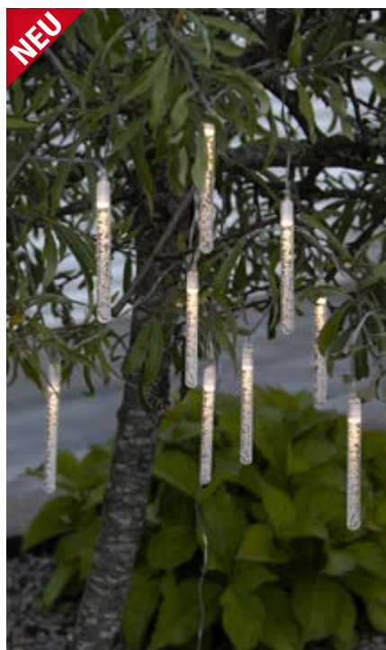
Solar-Lichterkette "Bubbly" IP44 Leitung schwarz, Glas Acryl klar mit Blasen H100mm Ø10mm, warmweiße LEDs, Solarmodul, Dämmerungsautomatik, Erdspeiß schwarz und Schalter Ein/Aus, NiMH-Akku 1,2V/300mAh, Leuchtzeit bei vollem Akku ca. 6 Stunden, Leitungslänge zur ersten LED ca. 2m, Abstand der Lichter 0,7m, Gesamtlänge ca. 2,5m, Solarmodul 50x60mm
