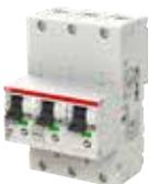
**Hauptsicherungsautomat S751/3DR 3x1-polig selektiv**, für **Montage auf** auf 35mm **Hutprofil-Schiene** nach DIN EN 60715, Schaltvermögen 25kA, Nennspannung 230/400V-AC, Stoßspannungsfestigkeit 6kV, mit Schaltstellungs-Anzeige und temperaturkompensiertem Überstromauslöser, spannungsunabhängig, integrierte Sperr- und Plombiermöglichkeiten, mit Schraubklemmen, geeignet für den Anschluss von ein-, mehr- und feindrähtigen Leitern bis 50mm<sup>2</sup>, B81xH130xT92mm, VDE
