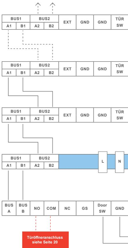
**HINWEIS:** Setzen Sie den Abschlusswiderstand, wenn VILLA M am Ende eines Videostranges installiert ist. Der Dipschalter Nr. 2 muss hierbei auf ON stehen.
